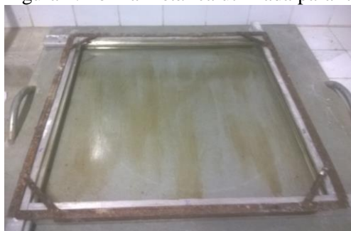
Figura 1. Fôrma metálica utilizada para fabricação das placas de gesso.
